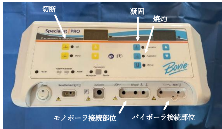
図 12. 電気手術装置。組織の凝固、切断、焼灼を行う能力、および単極および双極エネルギーの適用を提供する。
